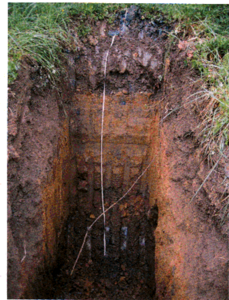
CALICATA C-15 PROFUNDIDAD FINAL = 2,70 MTS.
