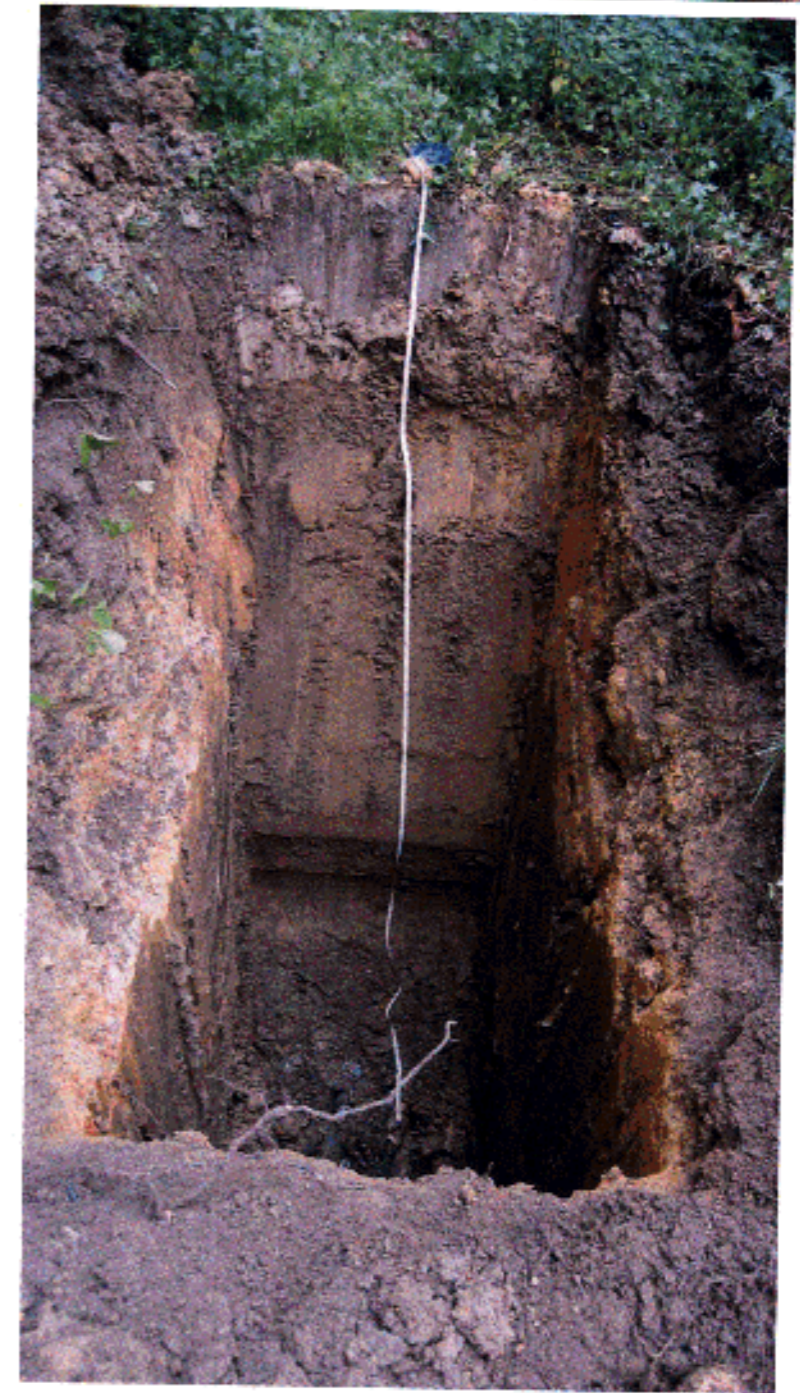
CALICATA C-9 PROFUNDIDAD FINAL = 3,80 MTS.
