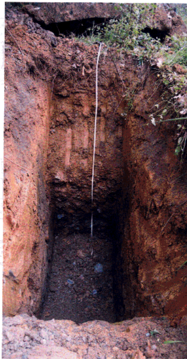
CALICATA C-20 PROFUNDIDAD FINAL = 3,20 MTS.
