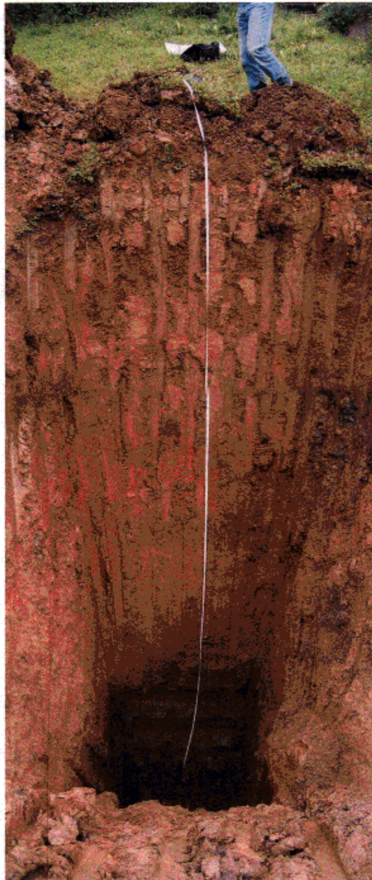
CALICATA C-4 PROFUNDIDAD FINAL = 5,40 MTS.
