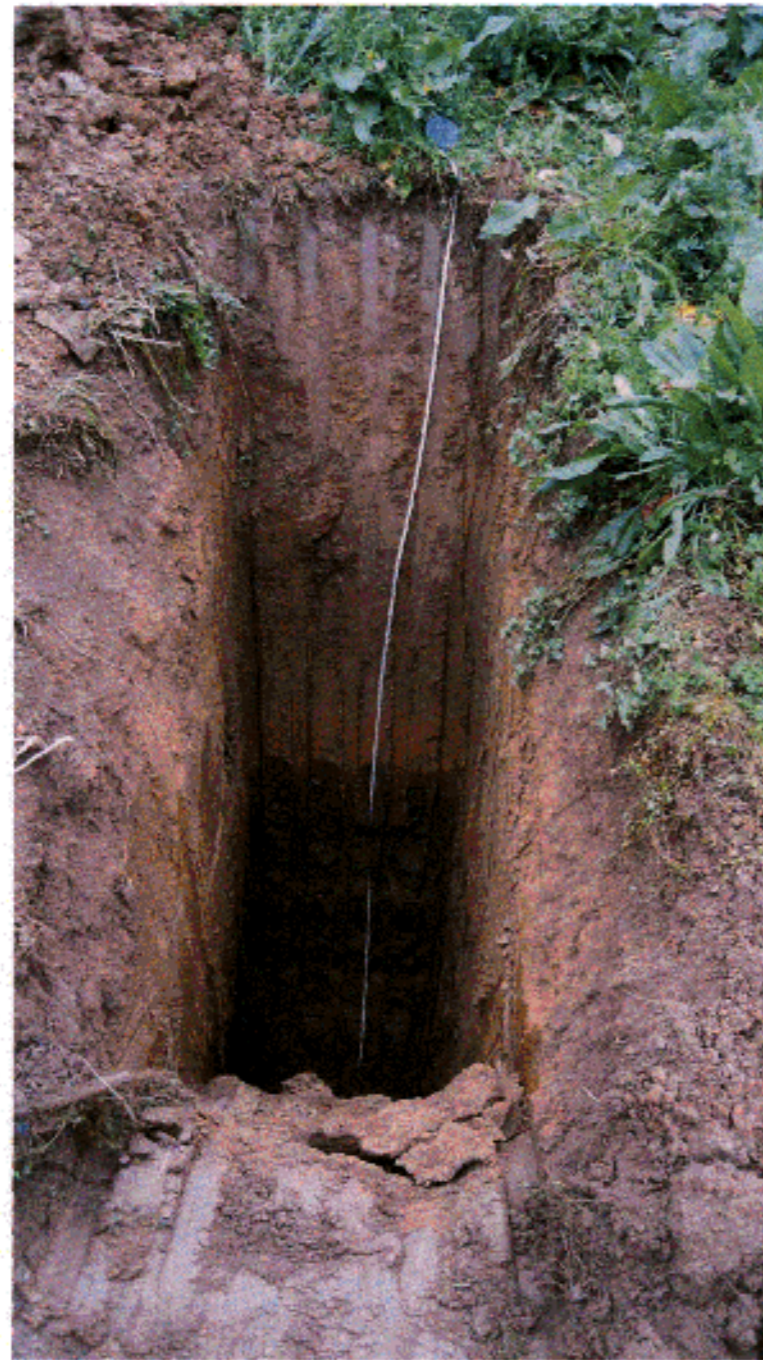
CALICATA C-13 PROFUNDIDAD FINAL = 4,80 MTS.
