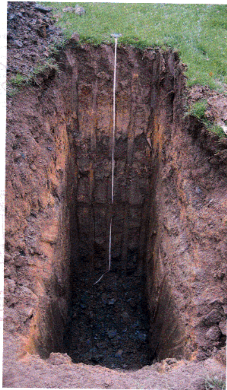
CALICATA C-8 PROFUNDIDAD FINAL = 4,30 MTS.
