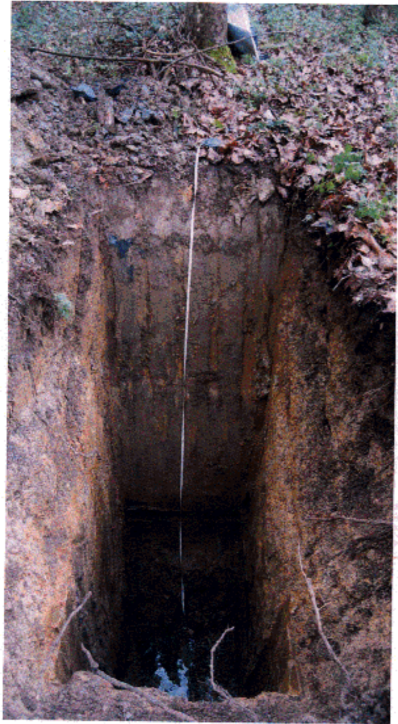
CALICATA C-7 PROFUNDIDAD FINAL = 4,30 MTS.
