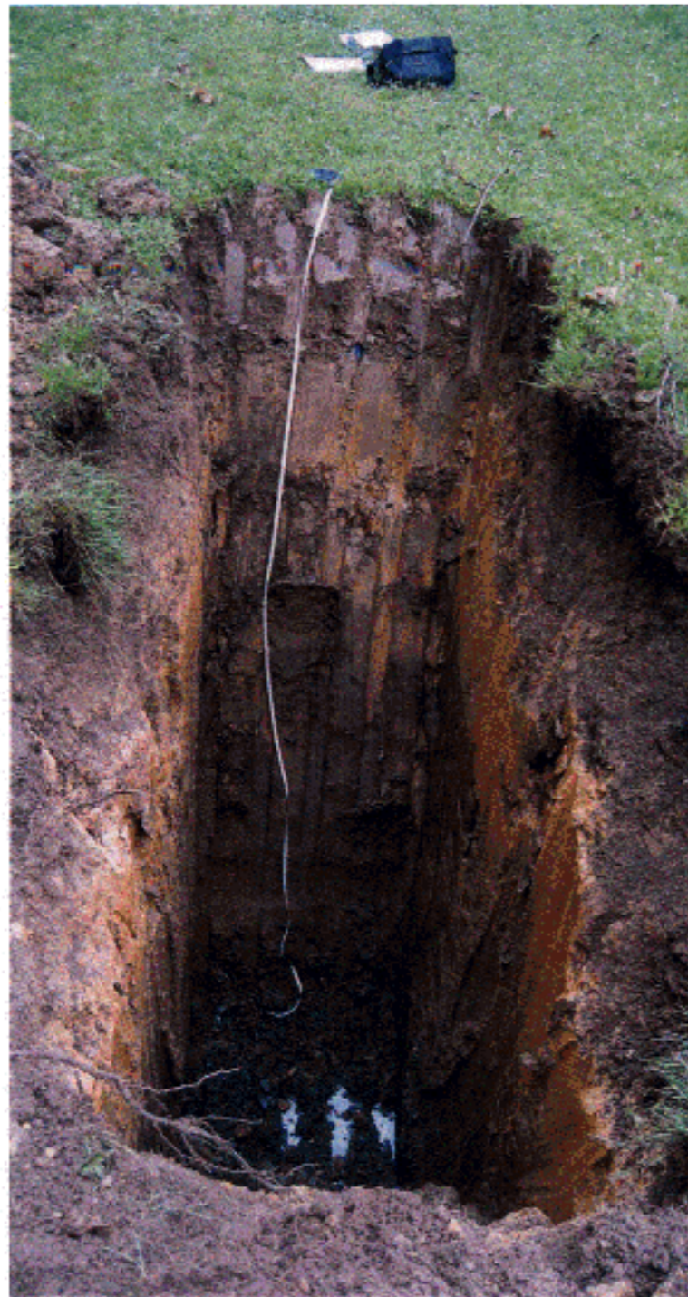
CALICATA C-10 PROFUNDIDAD FINAL = 3,70 MTS.
