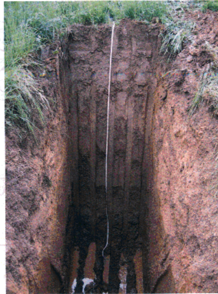
CALICATA C-17 PROFUNDIDAD FINAL = 2,80 MTS.
