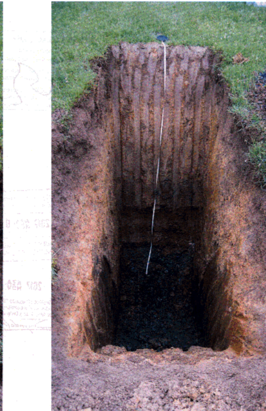
CALICATA C-11 PROFUNDIDAD FINAL = 3,00 MTS.
